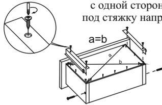
Для правильного открывания ящиков, необходимо выровнять диагонали каркаса ящика ( $a=b$ ) и только потом прибить ЛДВП не нарушая диагонали.
